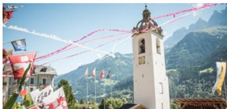
Classé monument historique en 1964, le clocher se termine non pas par un toit ou une flèche, mais par une balustrade sur laquelle s'appuient quatre arcs en maçonnerie, portant une lanterne à leur point d'intersection rappelant la forme d'une couronne fermée.
